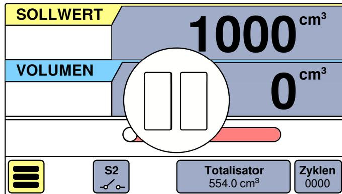
Im „Kapitel Grenzwerte“ wird erklärt, wie die Zeitüberschreitung zur Fernsignalisierung einem der 3 Relaiskontakt zugeordnet werden kann. Durch den Druck auf die rote Pause-/Reset-Taste wird der Alarm quittiert das Relais für die Fernsignalisierung fällt wieder ab.
