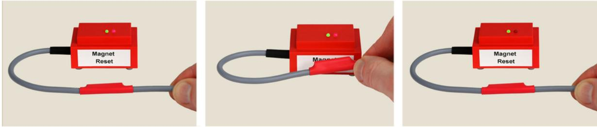
Zum Durchführen des Reset hält man den im Kabel integrierten und durch einen roten Schrumpfschlauch markierten Magnet an den Aufkleber mit der Aufschrift "MAGNET RESET".
