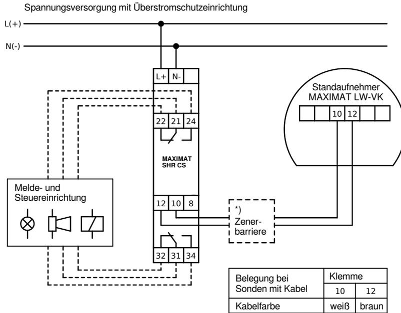
**Anschluss an Messumformer MAXIMAT SHR C19...**
