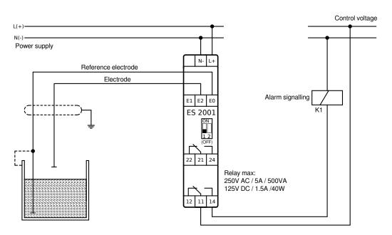
Overfill alarm (0-signal):
